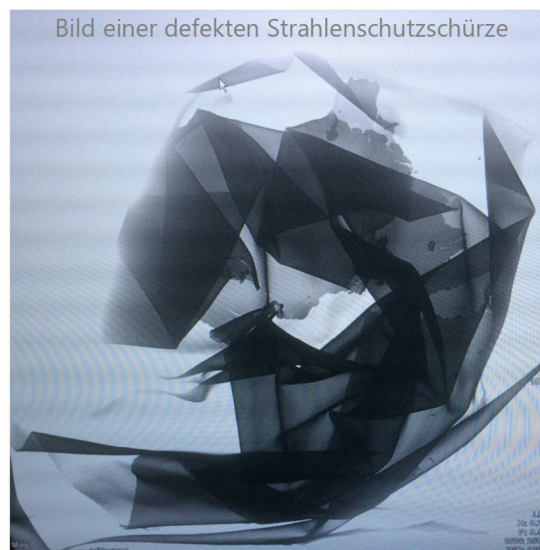
Beispiel: starker Materialbruch mit großflächiger Zerstörung der Schutzschicht.
