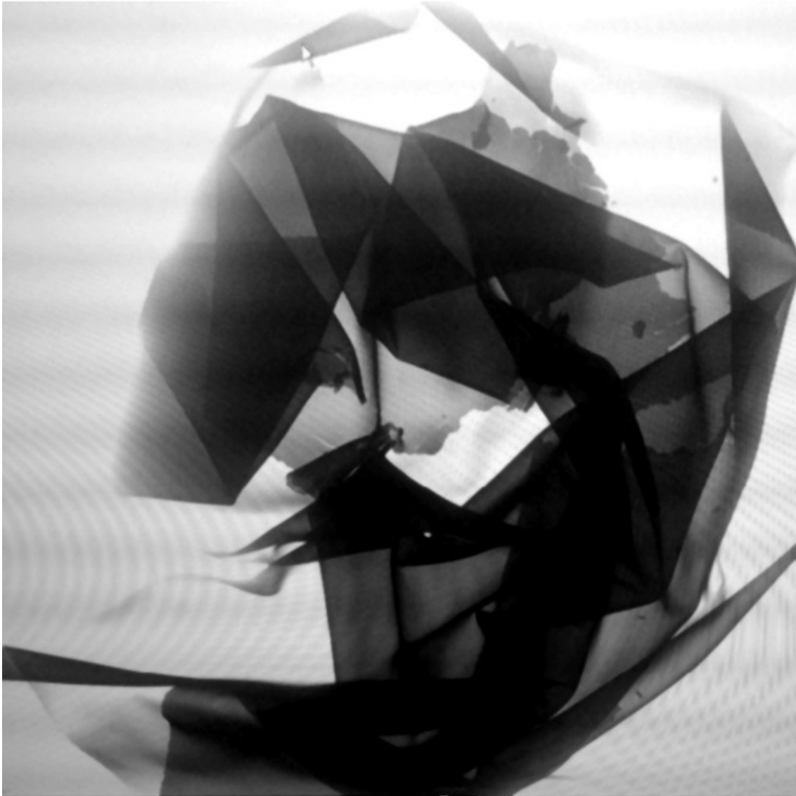
Materialbruch / Folienabriss der Frontschürze: großflächige Unterbrechungen der Schutzschicht.
