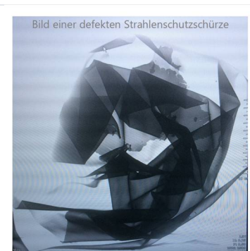
Starker Materialbruch / Folienabriss
