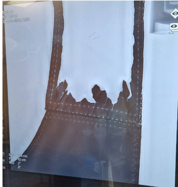
Beispiel: Schäden im Saumbereich mit Materialverlust und unregelmäßiger Schutzschicht.
