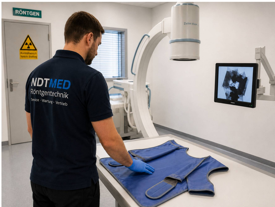
Beispiel: NDTMED-Prüfung im Röntgenraum mit Durchleuchtungsbild
