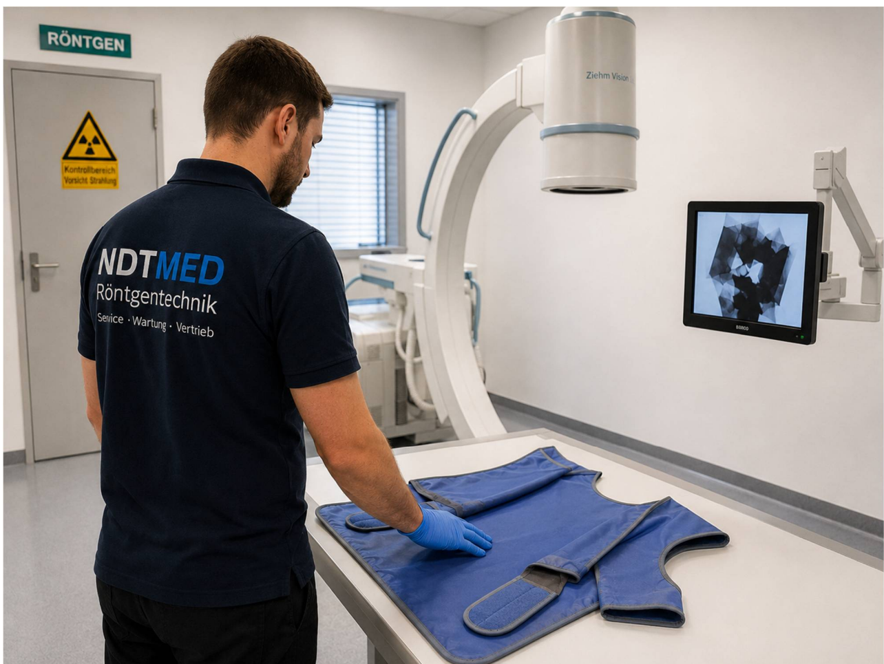
Praxisnahe Durchleuchtungsprüfung von Röntgenschutzkleidung im Röntgenraum.
